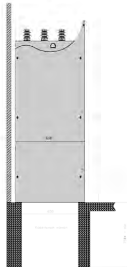
Рисунок 1.9.3 Установка камер КСО-3М в помещении РУ-6(10) кВ
