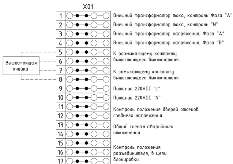
Рисунок 1.16.2 Клеммная колодка ячейки ввода.
